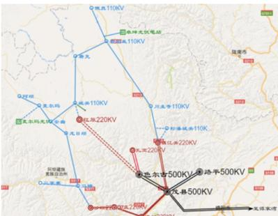
图：阿坝州地区电网主干图（蓝色为110KV线路，红色为220KV线路，黑色为500KV）
